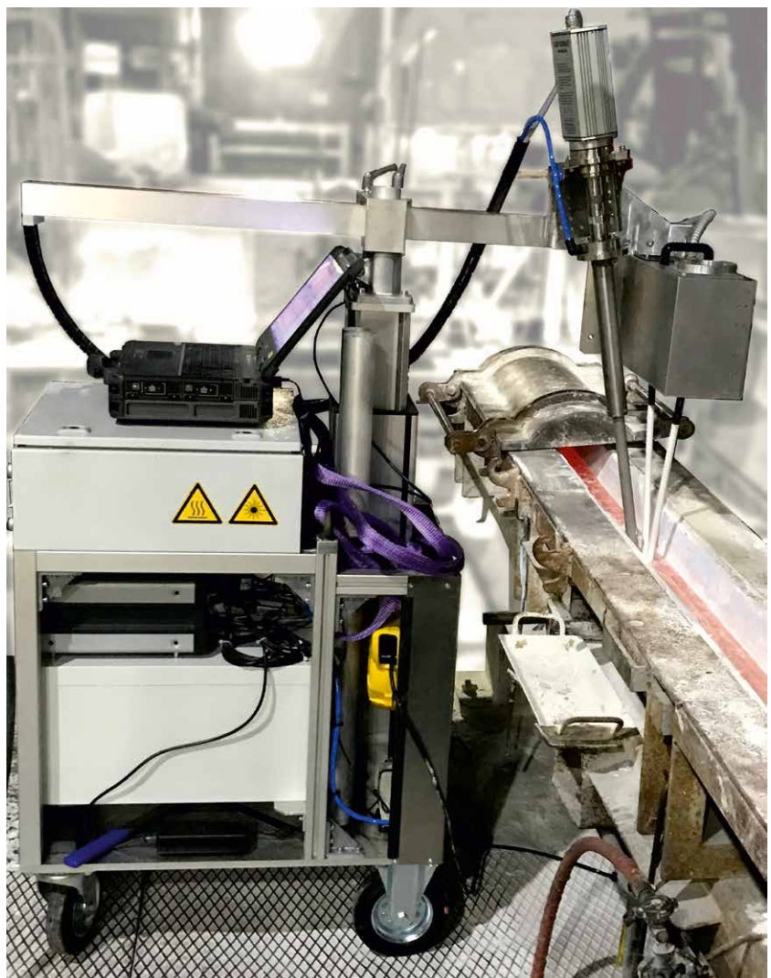
Bild 6: Einsatz des AloX in einer Rinne mit Al-Knetlegierung.
